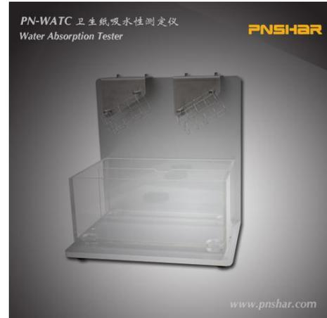
**工作原理：**在规定条件下，将试样放置在一个圆柱形的篮筐中，装有试样的圆柱形篮筐在自重的作用下浸入水中，测定试样完全润湿所需的时间。浸泡一定时间后，按规定的条件沥干试样，测定试样吸收水的质量。
